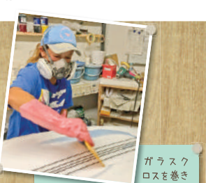
ガラスクロス巻く作業中。専用のマスクとキャップで防護しながら、真剣に取り組み表情が凛々(りんりん)!!
